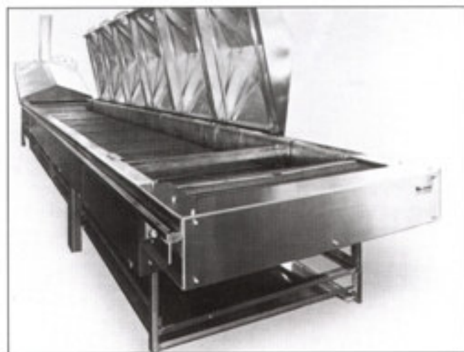
Drahtgeflechtsgurt mit seit- licher Hohlbolzenkette. Einsatz in einer Bratanlage.
