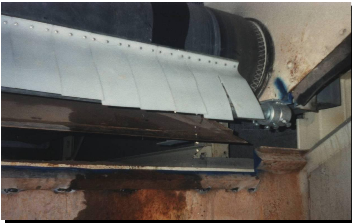
Előtisztító II: anyag beton, hevederszélesség 1200 mm
