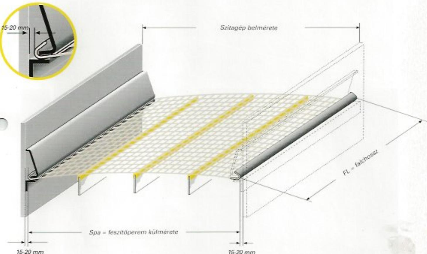
Az ISE-flex rostákat ugyanolyan módon kell beépíteni, mint a drótrostákat. A járatos menetek esetén az alkalmazandó meghúzási nyomaték a szövetvastagságtól függően 20 – 40 Nm.
