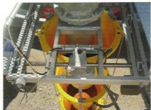
Dazu sind die elektrischen Kettzüge für die Höhenverstellung des Systems mit Begrenzungs- und Überlastungssensoren ausgestattet, um eine Überlastung und Beschädigungen der ISECONE – Teleskop-Schurre zu verhindern.
