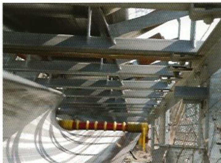
Die Untergurtrollen sind mit langlebigen Polyurethan-Stützringen aus dem Haus Isenmann bestückt.
