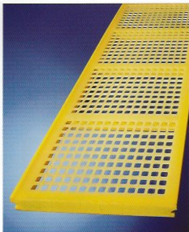
SPM = Spannmatte, Siebmatte mit kleinen Steghöhen, membranartig gespannt für sieb- schwieriges Siebgut
