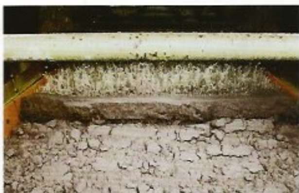
Stauleiste im Einsatz bei einer Sandentwässerung
