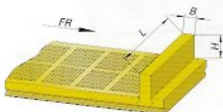
WS Stauleiste ... ab BH 40, nicht für Spaltguss einsetzbar
