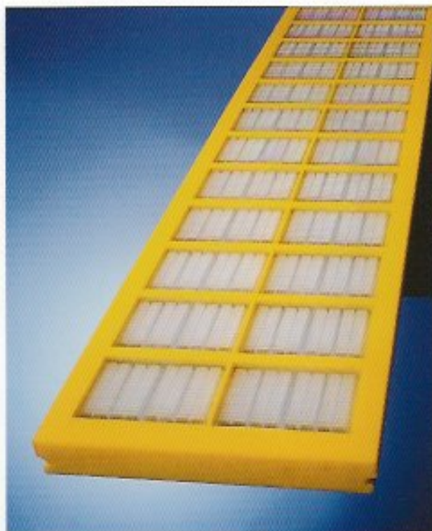
SG-HH = Segmentguss Siebmatten für die Entwässerung mit PU-thermoplastischen Segmenten für große Schichthöhen bis 300 mm
